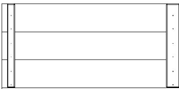
RP5 | W2A03269 - PANEL DERECHO DEL TECHO DEL PÓRTICO (1) | 1 5/8"x15 5/8"x32 7/8" (42x396x812)
