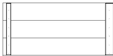
RP5 | W2A03269 - PANEL DERECHO DEL (1) | TECHO DEL PÓRTICO 1 5/8"x15 5/8"x32 7/8" (42x396x812)
